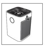
**3** 向下按两个固定夹,然后朝您自己的方向拉动预讨滤网。
