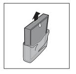
**4** 将无包装的空气净化滤网放回 产品内。
