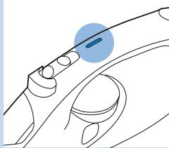
La función de desconexión automática de seguridad apaga automáticamente la plancha si no se utiliza durante 30 segundos mientras está sobre la base de apoyo o la suela o durante 8 minutos sobre su placa posterior. El piloto de desconexión automática se iluminará.
