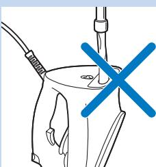
Ne versez pas d'eau, de vinaigre, de détartrants ni d'autres produits chimiques dans le fer par l'ouverture du Quick Calc Release.
