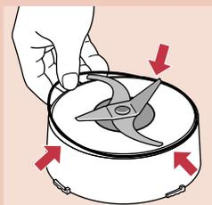
**2** 确保橡胶密封圈恰当地放置于干磨用刀叶装置上。
