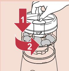
**4** 把蓋子放到器皿上，往下按，並按箭頭的方向旋轉它直到它完全裝牢為止，確保它安裝妥當之後再開動切割器。
