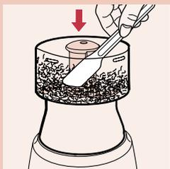
**5** 如果配料粘在碎肉杯的壁上，应关闭产品，用刮勺将食物推开。
