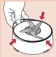
**2** 確保刀片單元上橡膠圈放置得恰當。
