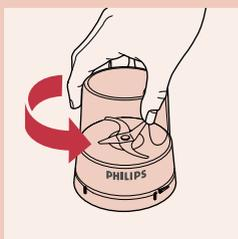
**4** 把装好了的干磨杯放在电机装置上，按箭头的方向转动干磨杯。
