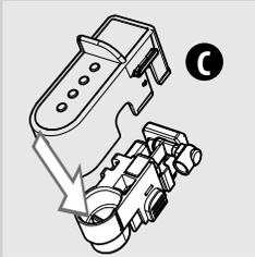
**6** Décrocher le couvercle (C) de la buse de distribution de la carafe à lait en exerçant une légère pression sur les côtés et en poussant vers le bas.
