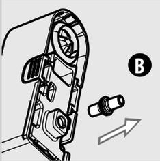
**5** Retirer le raccord (B) du mousser à lait en le tirant vers l'extérieur.
