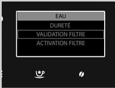
Dans **VALIDATION FILTRE** la machine prévient l'utilisateur lorsqu'il est nécessaire de remplacer le filtre à eau.
