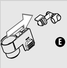
**8** Retirer le raccord (E) du mousser à lait en le tirant vers l'extérieur.
