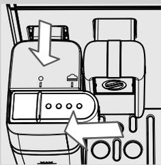
12 Réinsérer la buse de distribution de la carafe en la faisant glisser jusqu'au symbole «
