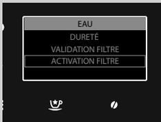
Dans **ACTIVATION FILTRE** on effectue l'activation du filtre après son installation ou son remplacement. Consulter le chapitre « Installation filtre à eau INTENZA+ ».
