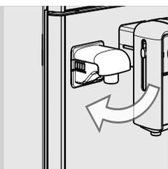
2 Appuyer et tourner la buse de distribution de l'eau vers le bas jusqu'à l'accrocher à la machine comme le montre la figure.
