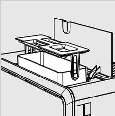
**6** Retirer le réservoir à eau en utilisant la poignée intégrée dans le couvercle intérieur.
