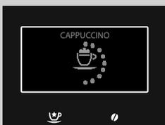
**9** La machine commence à distribuer le lait. Pour interrompre la distribution, appuyer de nouveau sur la touche correspondant à la boisson sélectionnée ; la distribution s'arrête après quelques secondes.
