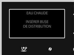
6 Le symbole ci-contre s'affiche. La machine indique d'installer la buse de distribution d'eau. S'assurer que la buse de distribution de l'eau est correctement installée. Appuyer sur la touche «
