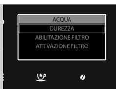
In **DUREZZA** è possibile impostare il grado di durezza dell'acqua. Per misurare la durezza dell'acqua, consultare il capitolo "Misurazione e programmazione durezza acqua".
