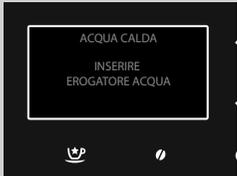
**6** Viene visualizzato il simbolo a lato. La macchina indica di installare l'erogatore dell'acqua. Verificare che l'erogatore acqua sia installato correttamente. Premere "✓" per confermare. La macchina inizia a erogare acqua calda.
