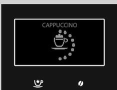
**9** La macchina inizia con l'erogazione del latte. Per interrompere l'erogazione, premere nuovamente il tasto della bevanda selezionata, l'erogazione terminerà dopo qualche secondo.
