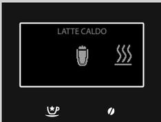
**10** La macchina necessita di un tempo di preriscaldamento: in questa fase viene visualizzato il simbolo a lato.
