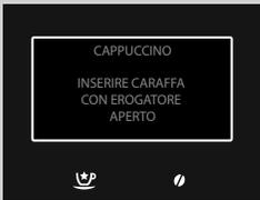
**6** La macchina ricorda che è necessario inserire la caraffa ed estrarre l'erogatore.
