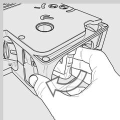
**12** Riportare il gruppo caffè in posizione di riposo ruotando manualmente il perno posto sulla base come mostrato nella figura a fianco e ruotarlo fino alla posizione di blocco descritta nel punto successivo.
