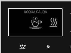
**7** La macchina necessita di un tempo di preriscaldamento: in questa fase viene visualizzato il simbolo a lato.
