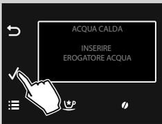
**10** Premere il tasto "✓". Terminata la fase di riscaldamento, la macchina inizia a erogare acqua.
