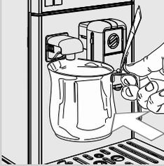
**7** Al termine dell'erogazione svuotare il recipiente e riposizionarlo sotto l'erogatore acqua.
