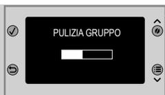
**7** Viene visualizzato il simbolo a lato. La barra consente di visualizzare lo stato di avanzamento del ciclo.
