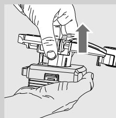
**6** Trekk ut håndtaket med oppsugingsrøret.
