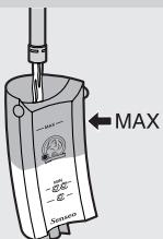
2 Füllen Sie den Wasserbehälter bis zur Markierung **MAX** mit kaltem Wasser, und setzen Sie ihn wieder in das Gerät.
