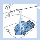
6 用温热的自来水冲洗冲煮器件的外表面并仔细清洁上层滤网。 切勿使用任何洗涤液或清洁剂清洁冲煮器件。
