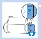
3 將濾網旋鈕旋轉至與您居住區域水質硬度相符的設定。
