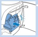
9 将冲煮器件沿着侧面的导轨滑回咖啡机中,直至其卡入到位。 请勿按 PUSH (按住拉出) 按钮。
