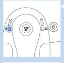
"水箱无水"指示灯持续亮起,表示水位过低。向水箱中注入清 水, 直至 MAX (最高) 水位标示,
