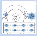
2 杯量指示灯和开/关按钮缓慢闪烁,表示咖啡机在设定要冲煮 的咖啡量。按照"使用咖啡机"一章中的"调整咖啡量"部分中 的说明进行操作。
