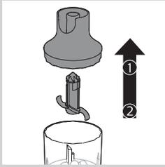
**9** Retirez soigneusement le couvercle du hachoir et l'ensemble lames (fig. 18).
