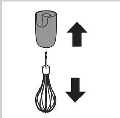
**10** Tirez sur le fouet pour le détacher de l'unité d'assemblage du fouet.
