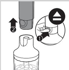
**8** Appuyez sur le bouton de déverrouillage pour détacher le bloc moteur du couvercle du hachoir.
