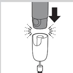
**2** Fixez l'unité d'assemblage du fouet au bloc moteur (« clic »).
