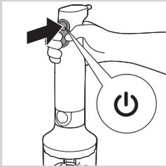
**6** Appuyez sur le bouton marche/arrêt ou sur le bouton TURBO et laissez fonctionner l'appareil jusqu'à ce que tous les ingrédients soient coupés.
