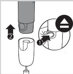
**9** Appuyez sur le bouton de déverrouillage pour détacher le bloc moteur de l'unité d'assemblage du fouet.
