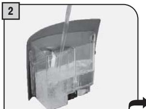
Eliminar el agua residual del depósito y llenarlo con la solución descalcificante.
