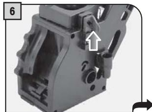
Asegurarse de que los componentes estén en la posición correcta. El gancho que se muestra tiene que estar en la posición correcta; para comprobarlo presionar el botón "PUSH".
