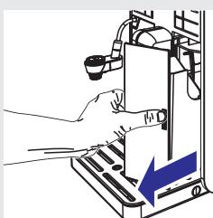
1. Ištuštinkite ir išvalykite kavos tirščių stalčiuką ir lašėjimo padékluką kiekvieną dieną išjungę aparatą.
