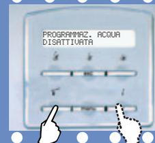
Scegliere se attivare o disattivare la programmazione dell'erogazione dell'acqua
