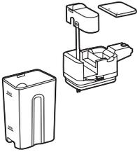
3 Soulevez la buse de distribution de la mousse de lait pour la sortir de la partie supérieure de la carafe.
