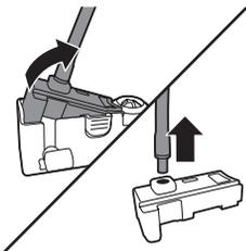
2 Retournez le couvercle de la buse de distribution à l'envers et maintenez-le fermement dans votre main. Retirez le tube d'aspiration du support en caoutchouc.
