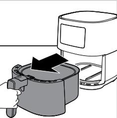
2 Retirez la cuve avec le panier de l'appareil en tirant sur la poignée.
