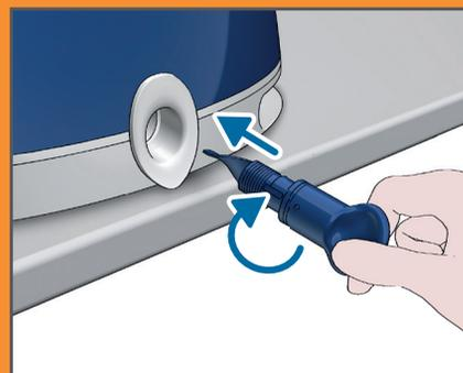
Lorsque toute l'eau est évacuée, réinsérez le bouton EASY DE-CALC et tournez-le dans le sens des aiguilles d'une montre pour le fixer.
