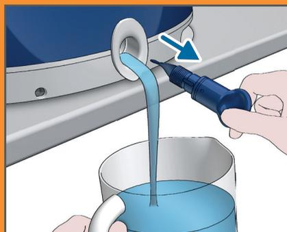
Enlevez le bouton EASY DE-CALC et laissez l'eau avec des dépôts de calcaire s'écouler dans la tasse.
