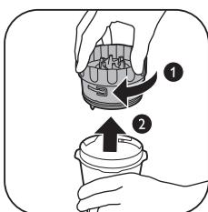
9 Okrenite jedinicu s rezačima mlinca u smjeru kazaljki na satu kako biste je odvojili od vrča.
