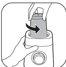
8 Tournez le bol dans le sens inverse des aiguilles d'une montre pour le retirer du bloc moteur.
