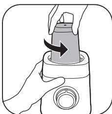
8 Ruotare il bicchiere in senso antiorario per rimuoverlo dalla base del motore.
