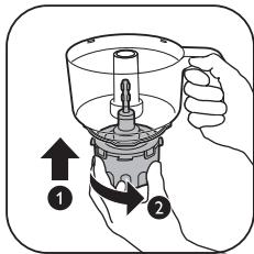
**1** Tournez l'unité d'assemblage dans le sens inverse des aiguilles d'une montre pour la fixer au bol du hachoir.
