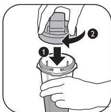
**12** Vri lokket på kolben med klokken for å låse det til kolben.
