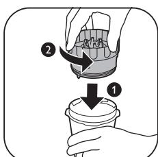
**2** A daráló aprítókését az óramutató járásával ellentétes irányba forgatva rögzítse az edényre.
