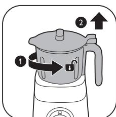
9 Ruotare il vaso del tritatutto in senso antiorario per rimuoverlo dalla base del motore.
