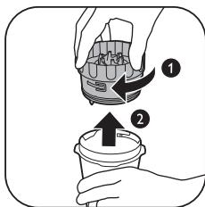
9 Drehen Sie die Messereinheit der Mühle im Uhrzeigersinn, um sie aus dem Becher zu entfernen.
