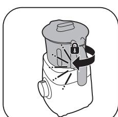
**4** Ruotare il vaso del tritatutto assemblato in senso orario per bloccarlo.
