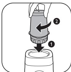
**3** Tournez le bol assemblé dans le sens des aiguilles d'une montre pour le fixer au bloc moteur.
