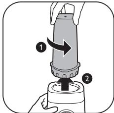
**10** Tournez la gourde assemblée dans le sens inverse des aiguilles d'une montre pour la retirer du bloc moteur.
