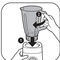
**3** Drej det samlede blenderglas med uret for at låse det fast på motorbasen.
