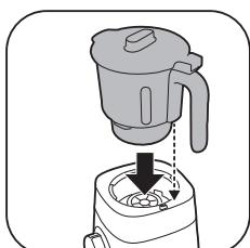
**3** Befestigen Sie den Mahlbecher an der Motorbasis.
