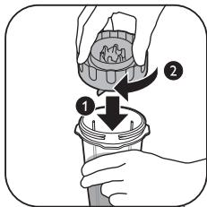
4 Drehen Sie die Messereinheit im Uhrzeigersinn, um sie im Becher zu fixieren.
