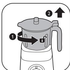
9 Fordítsa az őrlőedényt az óramutató járásával ellentétes irányba, és vegye le a motoregyiségről.
