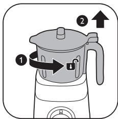
10 Tournez le couvercle du bol du broyeur dans le sens inverse des aiguilles d'une montre et retirez-le du bol.
