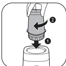
**3** Drehen Sie den zusammengesetzten Becher im Uhrzeigersinn, um ihn an der Motorbasis zu befestigen.
