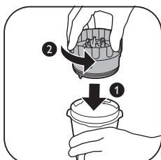
**2** Drehen Sie die Messereinheit der Mühle gegen den Uhrzeigersinn, um sie im Becher zu fixieren.
