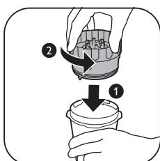
**2** Okrenite jedinicu s rezačima mlinca u smjeru suprotnom od kazaljki na satu da biste je pričvrstili na vrč.
