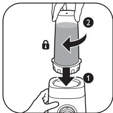
5 Drej det samlede beholderglas med uret for at låse det fast på motorbasen.
