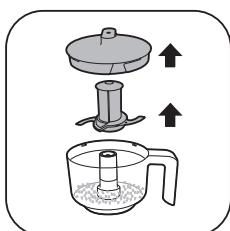
11 Zdejmij część tnącą rozdrabniacza oraz pokrywkę z pojemnika rozdrabniacza.
