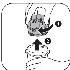
9 Tournez l'ensemble lames du moulin dans le sens des aiguilles d'une montre pour le retirer du bol.
