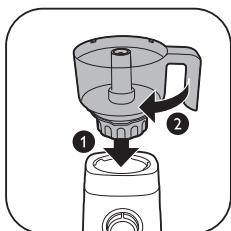
**2** Tournez le bol du hachoir assemblé dans le sens des aiguilles d'une montre pour le fixer au bloc moteur.
