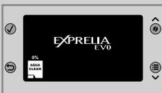
1 Lorsque le symbole du filtre commence à clignoter sur l'afficheur, appuyer sur la touche « ≡ » pour accéder au menu principal de la machine. Appuyer sur la touche « ✓ » et sur la touche « ✓ » pour sélectionner MENU MACHINE. Appuyer sur la touche « ✓ » pour sélectionner FILTRE AQUACLEAN.
