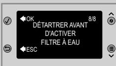
2 L'afficheur indique qu'il faut enlever le calcaire de la machine avant d'activer le nouveau filtre. Appuyer sur la touche « ✓ » pour démarrer la procédure d'élimination du calcaire.
