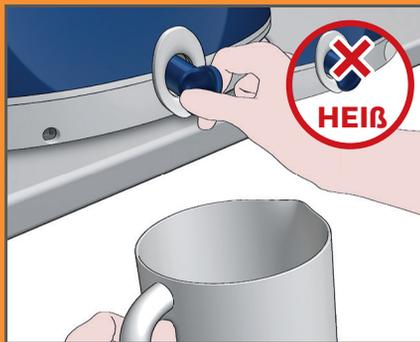
Stellen Sie die Dampfbügelstation an die Kante eines Tisches oder Waschbeckens, und halten Sie eine Tasse unter den EASY DE-CALC-Verschluss.
