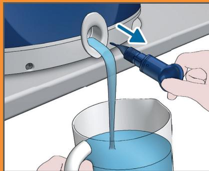
Entfernen Sie den EASY DE-CALC-Verschluss, und lassen Sie das Wasser mit Kalkpartikeln in die Tasse fließen.
