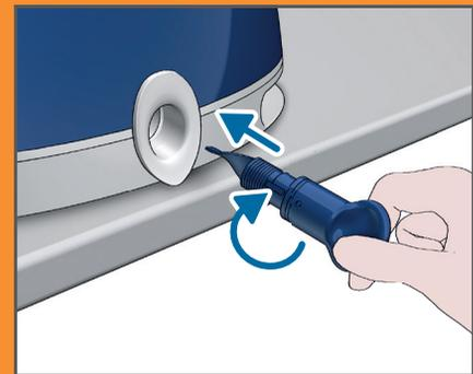
Wenn kein Wasser mehr austritt, setzen Sie den EASY-DE-CALC-Verschluss wieder auf, und drehen Sie ihn im Uhrzeigersinn fest.
