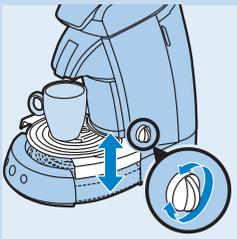
**4** Placez une ou deux tasses sous l'unité d'écoulement du café. Afin d'éviter les éclaboussures, tournez le bouton pour régler la hauteur du plateau égouttoir : le haut de la tasse doit se situer juste sous l'unité d'écoulement.
