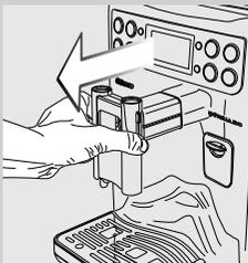
**6** Den Auslauf herausnehmen und mit Wasser reinigen.
