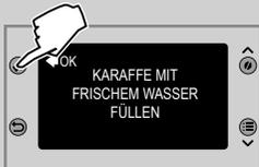
**14** Die Milchkaraffe sorgfältig reinigen und mit frischem Wasser füllen. Die Milchkaraffe in das Gerät einsetzen. Zur Bestätigung die Taste "✓" drücken.
