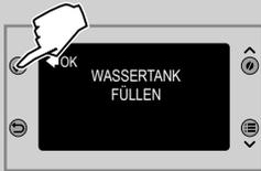
**12** Nach Abschluss der Ausgabe den Tank bis zum Füllstand MAX mit frischem Wasser füllen. Zur Bestätigung die Taste "✓" drücken.
