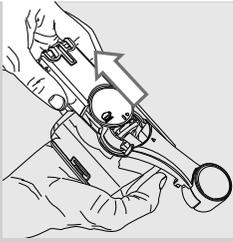
**5** Den Steckverbinder an das Gerät abnehmen.
