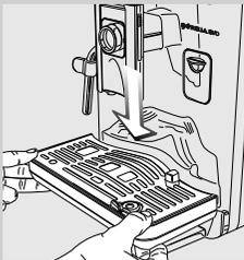
**5** Den Rost trocknen, wieder montieren und in das Gerät einsetzen.
