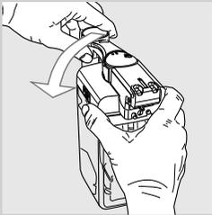
**7** Den Milchauslauf in die Sperrposition bringen, indem er im Gegenuhrzeigersinn gedreht wird.
