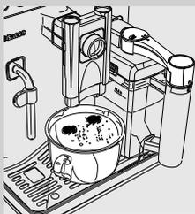
**4** Den Auslauf der Milchkaraffe öffnen, indem er im Uhrzeigersinn gedreht wird.
