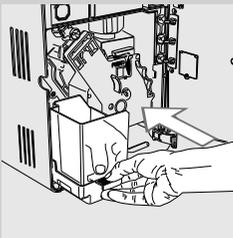
**6** Die Abtropfschale und den Kaffeesatzbehälter einsetzen und die Servicetür schließen.
