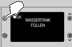
**4** Den Wassertank bis zum Füllstand MAX mit frischem Wasser füllen. Die Taste "✓" drücken.
