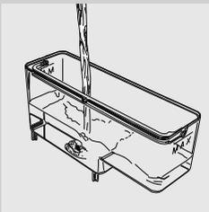
**1** Den kleinen weißen Filter oder den Filter AquaClean (soweit vorhanden) aus dem Tank herausnehmen und unter frischem Wasser reinigen.
