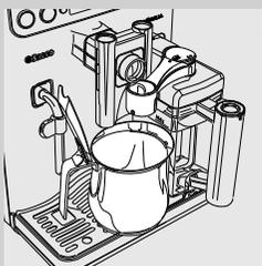
**15** Den Behälter leeren und unter den Kaffeeauslauf stellen. Den Milchauslauf öffnen, indem er im Uhrzeigersinn gedreht wird.
