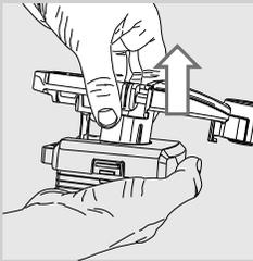
**6** Den Griff mit dem Ansaugschlauch herausnehmen.
