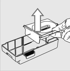
**4** Die Abtropfschale (intern) leeren und gemeinsam mit der Abdeckung mit frischem Wasser reinigen.
