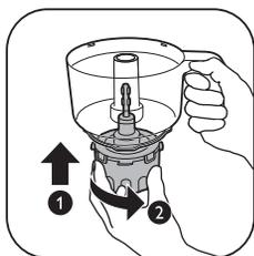
1 Obróć element łączący w lewo, aby przyłączyć go do pojemnika rozdrabniacza.
