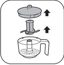
**11** Scoate blocul tăietor al tocătorului și capacul de pe castronul tocătorului.
