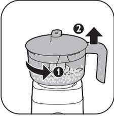
**10** Rotește castronul tocătorului în sens antiorar pentru a-l scoate de pe baza motorului.
