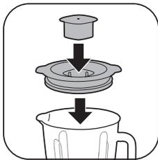
2 Fixez la mesure graduée sur le couvercle du bol du blender, puis fermez-le.
