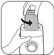
8 Obróć zlewkę w lewo, aby odłączyć ją od podstawy napędowej.
