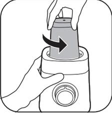
**8** Menzurkanı motor altlıqdan çıxarmaq üçün onu saat əqrəbinin əksi istiqamətində fırladın.
