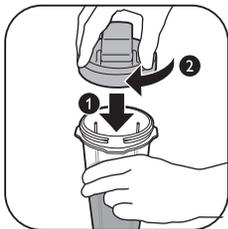
**12** Поверните крышку стакана по часовой стрелке, чтобы зафиксировать ее на кувшине стакана.
