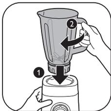
**3** Sestavljeno posodo mešalnika obrnite v smeri urnega kazalca, da se zaskoči na motorno enoto.
