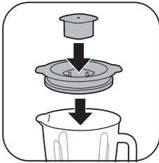
2 Setzen Sie den Messbecher auf den Deckel des Mixbehälters, und schließen Sie den Deckel.
