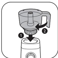
2 Obróć zestaw pojemnika rozdrabniacza w prawo, aby przyłączyć go do podstawy napędowej.
