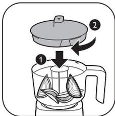
5 Поверните крышку чаши измельчителя против часовой стрелки, чтобы зафиксировать его на чаше измельчителя.
