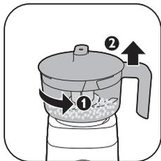
10 Поверните чашу измельчителя против часовой стрелки, чтобы снять ее с моторизованного основания.
