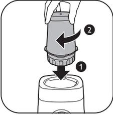
**3** Gire el vaso montado en sentido horario fijarlo a la base del motor.
