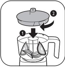
5 Drej låget til hakkeskålen med uret for at låse det fast på hakkeskålen.
