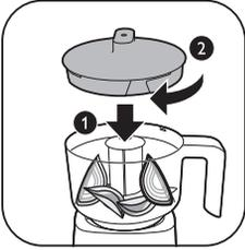
5 Tournez le couvercle du bol du hachoir dans le sens des aiguilles d'une montre pour le fixer au bol du hachoir.
