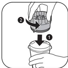
**2** Tournez l'ensemble lames du moulin dans le sens inverse des aiguilles d'une montre pour le fixer au bol.
