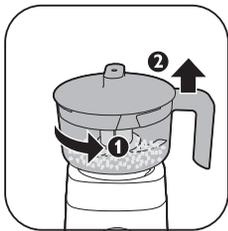
**10** Posodo sekljalnika obrnite v nasprotni smeri urnega kazalca, da jo odstranite iz motorne enote.
