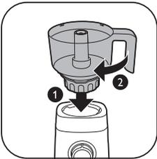
2 Rotește castronul tocătorului asamblat în sens orar pentru a-l fixa pe baza motorului.
