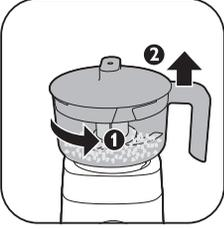
**10** Doğrayıcı qabını motor altlıqdan çıxarmaq üçün onu saat əqrəbinin əksi istiqamətində fırladın.
