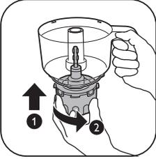
1 Birləşdirici qurğunu doğrayıcı qabına kilidləmək üçün onu saat əqrəbinin əksi istiqamətdə fırladın.
