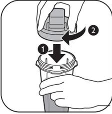
**12** Drehen Sie den Deckel des Bechers im Uhrzeigersinn, um ihn im Becher zu fixieren.
