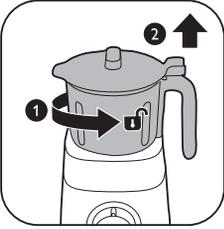
**9** Üydücü qabını motor altlığından çıxarmaq üçün onu saat əqrəbinin əksi istiqamətində fırladın.
