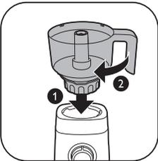
2 Gire el recipiente de la picadora ensamblado en sentido horario para fijarlo a la base del motor. Oirá un clic cuando se enganche.
