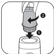
**3** Otočením sestavené nádoby mlýnku ve směru hodinových ručiček ji připevněte k motorové jednotce.
