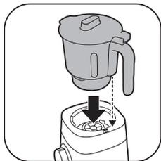
**3** Przyłącz dzbanek maszynki do mielenia do podstawy napędowej.
