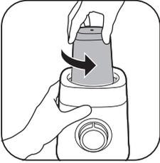
8 Gire el vaso en sentido antihorario para extraerlo de la base del motor.
