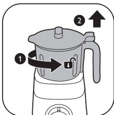
9 Obróć dzbanek maszyny do mielenia w lewo, aby go odłączyć od podstawy napędowej.
