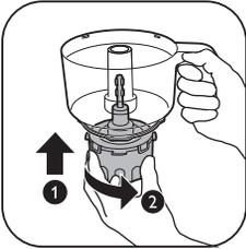
1 Rode o encaixe para a esquerda para o encaixar na taça da picadora.
