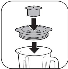
**2** Kiinnitä mittamuki tehosekoittimen kannun kanteen ja sulje kansi.
