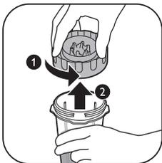
11 Okrenite jedinicu s rezačima u smjeru suprotnom od kazaljki na satu kako biste je odvojili od vrča za blendanje.
