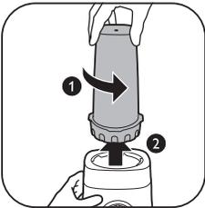
10 Gire la jarra del vaso montada en sentido antihorario para extraerla de la base del motor.
