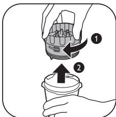
9 Поверните ножевой блок мельницы по часовой стрелке, чтобы снять его со стакана.
