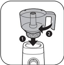
2 Vrid den monterade hackarskålen moturs för att låsa fast den på motorenheten.
