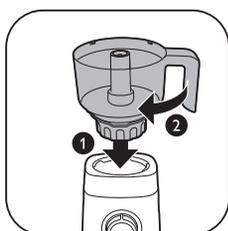
**2** Ruotare il recipiente del tritatutto assemblato in senso orario per bloccarlo sulla base del motore.
