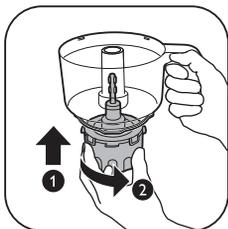
1 Otočením spojovací jednotky proti směru hodinových ručiček ji připevněte k misce sekáčku.
