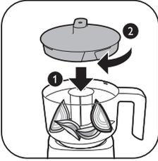
5 Drehen Sie den Deckel des Zerkleinerer-Behälters im Uhrzeigersinn, um ihn am Zerkleinerer-Behälter zu befestigen.
