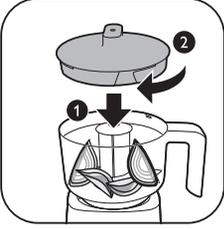
5 Doğrayıcı qabının qapağını doğrayıcı qabına kilidləmək üçün onu saat əqrəbi istiqamətində fırladın.
