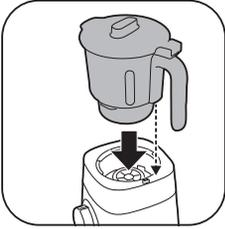
3 Coloque la jarra del molinillo en la base del motor.
