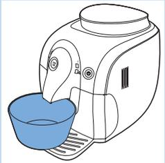
Lorsque la machine a fini de chauffer, elle effectue un cycle de rinçage automatique pour nettoyer le circuit interne avec de l'eau fraîche. Cette opération dure environ une minute.
