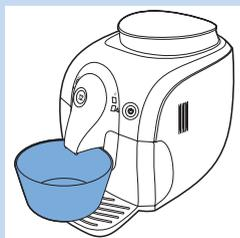
Pendant le processus de chauffe initial, de l'eau fraîche s'écoule par le circuit interne pour chauffer la machine. Cela prend quelques secondes.
