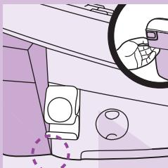
**1** Retire o reservatório destacável para fora do reservatório de vapor.
