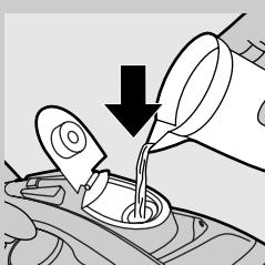
**4** Наклоните утюг назад и заполните водонаборный контейнер водопроводной водой через колпачок наливного отверстия до максимального уровня.
