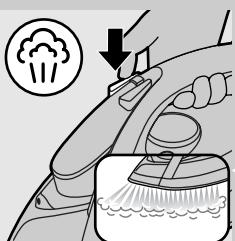
Направлений вперед концентрований струмінь пари покращує розподіл пари на кожну частину одягу. Функція концентрованого струменю пари може застосовуватися лише за температури від ●● до MAX.
