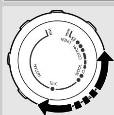
**1** Postavite likalnik pokonci, na njegovo peto in nastavite zahtevano temperaturo likanja z obračanjem temperaturnega regulatorja do primerenega položaja.
