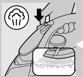
Направленный вперед концентрированный паровой удар улучшает его распределение в каждой детали текстильного изделия. Эту функцию можно использовать только для температурных режимов от ●● до MAX.
