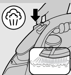
Naprej usmerjen koncentriran sunkoviti izpust pare izboljša porazdelitev pare na vsak košček oblačila. Koncentriran sunkoviti izpust pare se lahko uporablja le pri nastavivah temperature med ●● in MAX.
