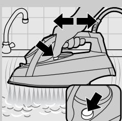
Ze dna žehličky začne vystupovat horká voda s párou a odplaví současně všechny nečistoty (pokud jsou přítomny).
