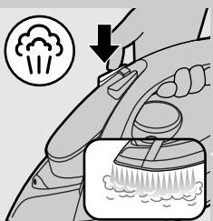
Šo funkciju var izmantot, gludinot augstā temperatūrā, lai izlīdzinātu grūti izgludināmas krokas.
