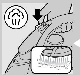
Мощный паровой удар позволяет разгладить неподатливые складки. Функция «паровой удар» может использоваться только в диапазоне температур от ●● до MAX.
