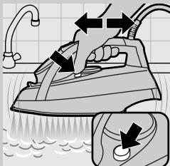
**6** Ko temperaturna lučka ugasne, likalnik izključite iz električnega omrežja.
