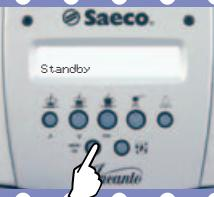
Erscheint, wenn sich die Maschine in einer OFF-Zeit befindet. Zur Aktivierung "OK" drücken.
