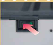
Druk de schakelaar in stand "I" om het apparaat in te schakelen.
