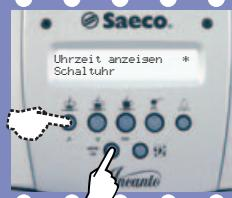
Mit den Tasten "˄" und "˅" anwählen und mit der Taste "OK" zur Anzeige der Uhrzeit aktivieren.
