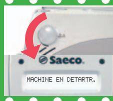
Ouvrir le robinet. La machine commence l'opération de détartrage.
