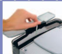
Tremper la bande dans l'eau pendant 1 seconde. Vérifier combien de carrés changent de couleur.
