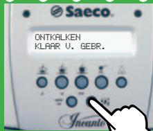
Druk 5 seconden op de knop wanneer het apparaat dit aangeeft.
