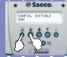
Sélectionner le rétablissement de la programmation machine avec la configuration initiale ou pas.
