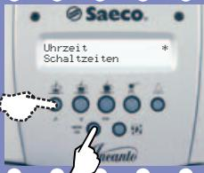
Mit den Tasten "˄" und "˅" anwählen und mit der Taste "OK" zur Einstellung der Uhrzeit aktivieren.
