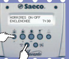
Programmer l'heure de mise sous tension de la machine.
