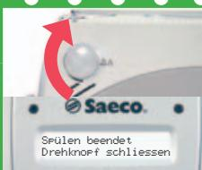
Am Ende des Spülvorgangs den Drehknopf schließen und den Kreislauf füllen.
