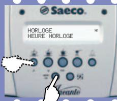
Menu pour activer l'heure de mise sous tension et hors tension de la machine.
