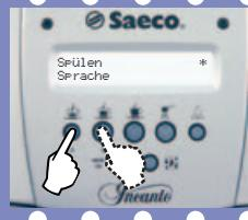
Mit den Tasten „^“ und „v“ werden die Menüs angezeigt/geändert.
