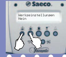
Anwählen, ob die Programmierungen der Maschine wieder auf die Werkseinstellungen zurückgesetzt werden sollen.
