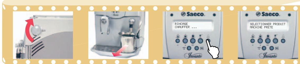
Fermer le robinet pour interrompre le chargement du circuit.
