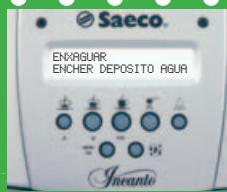
Enxagar e encher o depósito com água fria potável.
