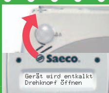
Der Drehknopf kann zum Unterbrechen des Entkalkungs-vorgangs geschlossen werden.
