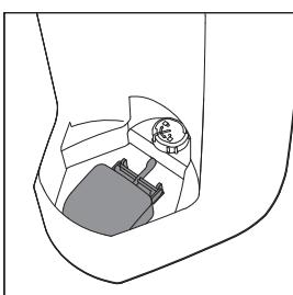
**5** 用手按压浮球杆前端，确保浮球可以上下弹动；并且轻轻拉动浮球杆，确保它不会从支架中弹出。
