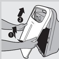
**1** 将手指放在侧面板的凹处，然后面向您的方向轻轻拉出前面板的下半部分。提拉面板顶部的挂钩，将其从产品顶部拉出来。
