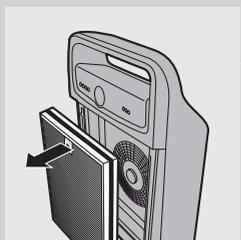
**4** 要卸下过滤网 2（复合多效净化过滤网），请抓住其拉片，然后朝您的方向拉动。
