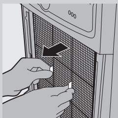
**3** 要卸下过滤网 1（预过滤网），请抓住两个凸缘，然后朝您的方向拉动过滤网。
