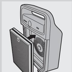
**6** 将过滤网 2（复合多效净化过滤网）放回产品中。
