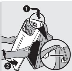
**8** 要装回前面板，请首先将两个挂钩插到产品顶部（1）。然后，朝产品机身方向推动面板（2）。
