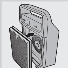
**5** 将过滤网 2（复合多效净化过滤网）放回产品中。
