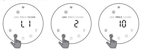
• 轻触 Q 按钮可在 PM2.5/气态污染物读数/过敏原之间切换显示指示灯。
