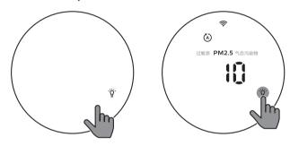
借助光感应器,控制面板可根据环境光线自动打开、关闭或变暗。在环境光线较暗时,控制面板的亮度也将变暗或关闭。此时轻触控制面板的按键区,可以唤醒控制面板查看空气情况。如果没有进一步操作,指示灯和控制面板将再次变暗,继续保持与环境光线相匹配。
