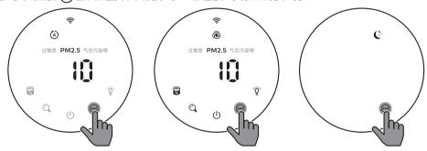
自动模式(②):在自动模式下,双传感器实时感应空气质量,设备会根据环境空 气质量自动调整风扇速度。
