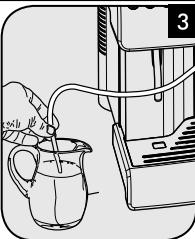
**CHN** 将干净的管子直接插入牛奶容器中。
