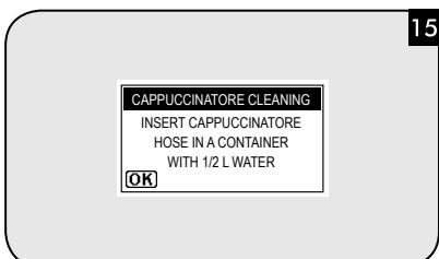
冲洗容器并注入 1/2 升清水，然后将 Cappuccinatore（自动奶泡器）软管再次插入其中。
