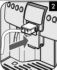
**CHN** 将 Cappuccinatore (自动奶泡器) 安到底座上，锁定到位。
