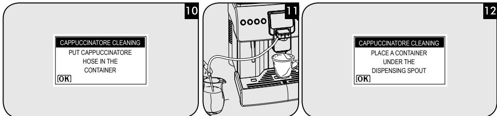
**CHN** 将干净的管子直接插入该容器。按 按钮确认。
