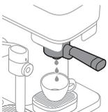
8 La machine chauffe et commence à rincer le diffuseur avec de l'eau qui coule dans la tasse par le bec verseur du porte-filtre. Le bouton Extra Intensité continuera à clignoter lentement pendant toute la durée de ce processus.
