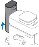
**3** Verwijder het waterreservoir van het apparaat.
