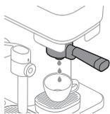
**7** La machine chauffe et commence à rincer le diffuseur avec de l'eau qui coule dans la tasse par le bec verseur du porte-filtre. Le bouton Extra Intensité continuera à clignoter lentement pendant toute la durée de ce processus.
