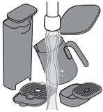
Demonteerbare onderdelen zijn bijvoorbeeld: waterreservoir en deksel, lekbak voor melk en deksel, lekbak en deksel, deksel van koffiebonenreservoir en kan. Je kan alle demonteerbare onderdelen onder warm stromend water reinigen met wat mild, geurloos afwasmiddel en een zachte spons.
