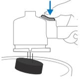
Met deze uitwerpknop kan je eenvoudig het koffiedik na elke koffiebereiding verwijderen. Verwijder het koffiedik door de portafilter ondersteboven te houden en op de uitwerpknop te drukken.
