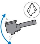
4 Secouez le porte-filtre pour enlever l'excès d'eau et séchez l'intérieur et l'extérieur avec un chiffon.
