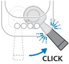
Met de functie voor onmiddellijk starten kan je gemakkelijk je apparaat aanzetten en heerlijke koffie zetten of melk opschuimen. Er is geen aan/uit-knop. Druk gewoon op de knop van de drank die je wilt bereiden en beweeg de portafilter naar rechts om te malen en te bereiden. Wanneer je op de schuimknop hebt gedrukt, begint het apparaat automatisch met opwarmen en stomen.
