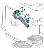
1 Bewege den smarten Aufschäumer nach oben, und drehe den Aufschäumer-Kopf nach links (1), während du ihn leicht nach unten ziehst (2), um ihn einfach von der Maschine zu entnehmen.
