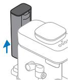
**3** Retirez le réservoir d'eau de la machine.
