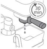
**6** Het apparaat doseert de volledige ontkalkingsoplossing met regelmatige tussenpozen afwisselend via de koffie-uitloop en het slimme stoompijpje. Dit duurt maximaal 30 minuten.
