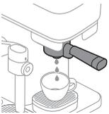
8 Het apparaat warmt op en begint water uit de koffie-uitloop in de kop te spoelen. De knop voor extra intensiteit blijft tijdens dit proces langzaam knipperen.
