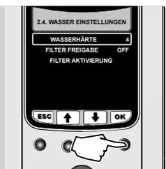
7 Die Option **“WASSERHÄRTE”** anwählen; die Taste **“OK”** drücken, um das Menü zu öffnen.
