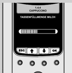
Durch Einstellung des Balkens auf dem Display mit den Tasten "" oder "" kann die Milchmenge für die Zubereitung des angewählten Getränks angewählt werden. Die Taste "" drücken, um die Einstellung zu bestätigen.
