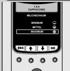
In diesem Bereich kann die Milchaufschäumung programmiert werden:
