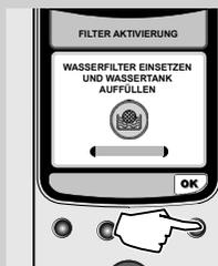
12 Die Taste "OK" drücken, um den Einsatz des Wasserfilters und die Füllung des Tanks zu bestätigen.
