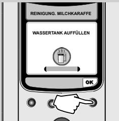
**12** Nach Abschluss der Ausgabe den Tank bis zum Füllstand MAX mit frischem Wasser füllen. Zur Bestätigung die Taste "OK" drücken.
