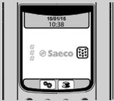
Das Gerät muss entkalkt werden. Hierzu sind die Vorgänge, die im Kapitel "Entkalken" der vorliegenden Bedienungsanleitung beschrieben werden, zu beachten.
