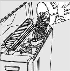
**10** Die Kaffeebohnen langsam in den Behälter einfüllen. Den inneren Deckel wieder aufsetzen und den Außendeckel schließen.
