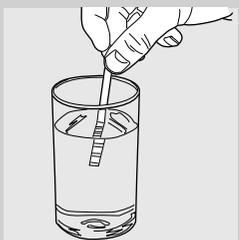
**1** Den Teststreifen zum Bestimmen der Wasserhärte (im Lieferumfang des Geräts enthalten) für einen Zeitraum von 1 Sekunde in das Wasser eintauchen.
