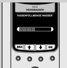
Durch Einstellung des Balkens auf dem Display mit den Tasten "↑" oder "↓" kann die ausgegebene Menge an heißem Wasser angewählt werden. Die Taste "OK" drücken, um die Einstellung zu bestätigen.
