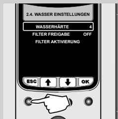
9 Um die Funktion zu verlassen, wird die Taste **“ESC”** mehrmals gedrückt, bis wieder die Hauptdisplay angezeigt wird.
