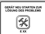
Den Code (E xx) notieren, der unten auf dem Display aufgeführt wird. Das Gerät ausschalten. Nach 30 Sekunden erneut einschalten. Den Vorgang 2 oder 3 Mal wiederholen.
