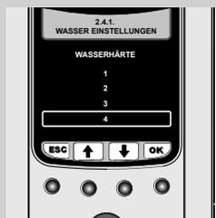
8 Den Wert der Wasserhärte programmieren, indem die Tasten **“↓”** oder **“↑”** gedrückt werden. Zur Bestätigung die Taste **“OK”** drücken.
