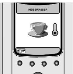
**4** Die Maschine benötigt eine Vorwärmzeit. In dieser Phase wird das folgende Symbol angezeigt.
