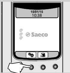
**4** Nun können die Einstellungen der Wasserhärte programmiert werden. Die Taste "☰" drücken, um das Hauptmenü des Geräts zu öffnen.
