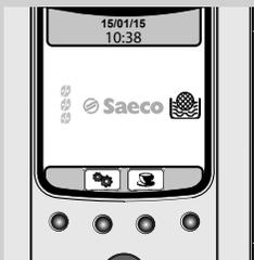
Wenn der Austausch des Wasserfilters "INTENZA+" erforderlich ist, wird das Symbol "☼" angezeigt.
