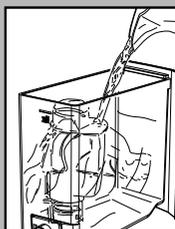
Den Tank mit frischem Trinkwasser füllen und wieder in die Maschine einsetzen.
