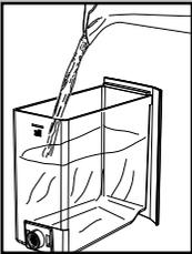
19 Den Wassertank herausnehmen, ausspülen und bis zum Füllstand MAX mit frischem Trinkwasser füllen.
