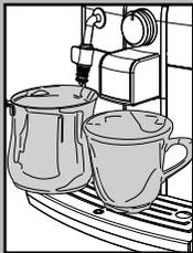
6 Einen leeren Behälter unter die Dampf- / Heißwasserdüse und einen Behälter unter den Auslauf stellen.
