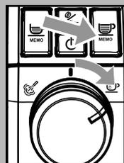
15 Leuchtet die Taste "MEMO" dauerhaft auf, den Wahlschalter im Uhrzeigersinn auf "☺" drehen. Auf diese Weise wird das Spülwasser dauerhaft aus der Dampf- / Heißwasserdüse ausgegeben.
