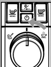
9 Den Wahlschalter in die mittlere Position "☺" drehen. Den Behälter unter der Dampf- / Heißwasserdüse und den Behälter unter dem Auslauf leeren.
