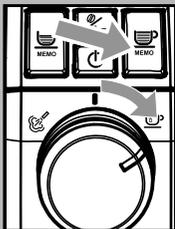
7 Leuchtet die Taste "MEMO" dauerhaft auf, den Wahlschalter im Uhrzeigersinn bis "☺" drehen. Auf diese Weise wird der Entkalker in regelmäßigen Intervallen über die Dampf-/Heißwasserdüse ausgegeben.
