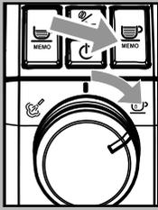
**i Hinweis:** Wenn die Taste "MEMO" unverzüglich nach dem Start dauerhaft aufleuchtet, erfordert die Maschine eine Entlüftung des Systems. Den Wahlschalter im Uhrzeigersinn bis "☺" drehen. Wenn das Symbol "▲" angezeigt wird, den Wahlschalter wieder in Position "☺" stellen.
