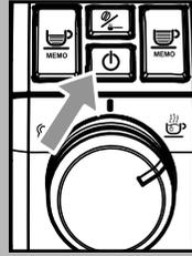
22 Nach Abschluss des zweiten Spülzyklus schaltet die Maschine auf Standby und die Taste "☺️" blinkt.
