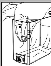
Den kleinen weißen Filter aus dem Tank herausnehmen, an einem trockenen Ort aufbewahren und vor Staub schützen.
