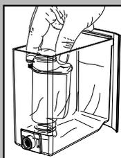
Den Wasserfilter in den leeren Tank setzen. Bis zum Einrasten drücken.
