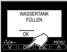
**12** Nach Abschluss der Ausgabe den Tank bis zum Füllstand MAX mit frischem Wasser füllen. Zur Bestätigung die Taste "OK" drücken.
