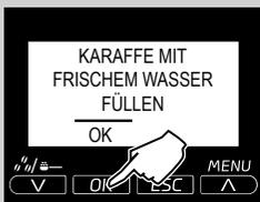
**14** Die Milchkaraffe sorgfältig reinigen und mit frischem Wasser füllen. Die Milchkaraffe in die Maschine einsetzen. Zur Bestätigung die Taste "OK" drücken.
