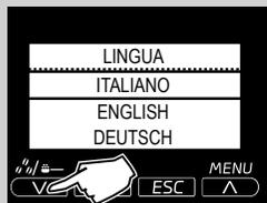
**13** Die folgende Displayansicht wird angezeigt. Die gewünschte Sprache durch Druck der Tasten "V" oder "∧" auswählen.
