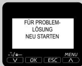
Den Code (E xx) notieren, der unten auf dem Display aufgeführt wird. Die Maschine ausschalten. Nach 30 Sekunden erneut einschalten. Den Vorgang 2 oder 3 Mal wiederholen.
