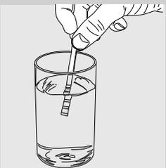
**1** Den Teststreifen für die Wasserhärte, der mit der Maschine geliefert wird, für einen Zeitraum von 1 Sekunde in das Wasser eintauchen.
