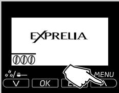
**4** Nun können die Einstellungen der Wasserhärte programmiert werden. Die Taste "MENU" drücken, um das Hauptmenü der Maschine zu öffnen.
