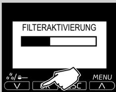
**14** Die Maschine beginnt, Wasser auszugeben. Die folgende Displayansicht wird angezeigt. Nach der Ausgabe den Behälter entfernen.
