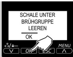
**10** Die Abtropfschale (intern) leeren und wieder einsetzen, dann die Taste "OK" drücken.
