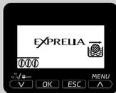
Die Maschine zeigt an, dass der Wasserfilter "INTENZA+" ausgetauscht werden muss.
