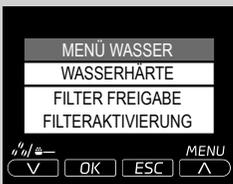
**7** Die Option WASSERHÄRTE durch Druck der Taste "OK" anwählen und den Wert der Wasserhärte programmieren.
