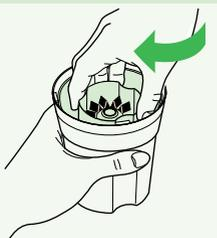
3 將攪拌刀座旋緊在研磨杯上。
