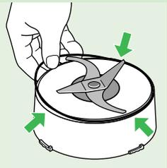
**2** 确保橡胶密封圈恰当地放置于干磨用刀叶装置上。
