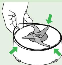
2 確定刀組上的橡膠圈已固定於定位。
