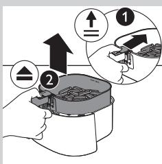
**11** Чтобы достать небольшие ингредиенты (например, картофель фри), снимите корзину с противня, снимите крышку и нажмите кнопку отсоединения корзины.
