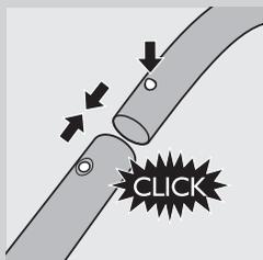
**1** 将伸缩管与软管的握把连结时，按下握把上的弹簧锁按钮，将握把插入吸管。将弹簧锁按钮对准，插入硬管的开口（听到喀哒一声）。
