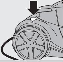
**2** 按下电源线回卷按钮将电线回卷到吸尘器中。
