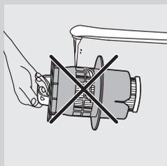
请勿将带滤芯的滤芯罩放在水龙头下清洗。
