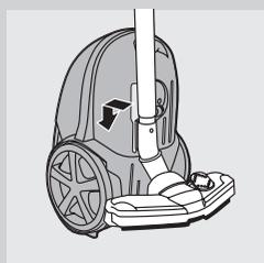
**3** 請將產品直立放置，並將吸頭上的突出物插入收藏槽，讓吸頭固定在產品上。
