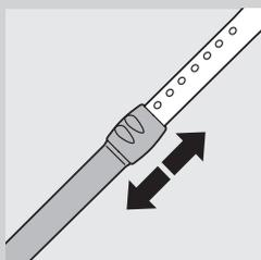
**3** 将硬管调整到吸尘过程中感觉最舒适的长度。
