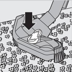
**4** 存放时，必须先将全方位吸尘嘴置于地毯设置（刷条缩入吸嘴）。同时防止侧毛刷弯曲。
