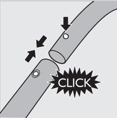
**1** 按下握把上的彈簧鎖定按鈕，將握把插入吸塵管，即可將吸塵管連接至軟管上的握把。將彈簧鎖定按鈕卡進吸塵管上的開孔 (會聽見「喀噠」一聲)。
