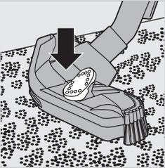
4 Tri-Active 노즐을 보관할 때는 항상 카펫 설정(브러시 솔 부분이 노즐 속으로 들어간 상태)으로 두십시오. 또한 측면 브러시가 휘어지지 않도록 하십시오.
