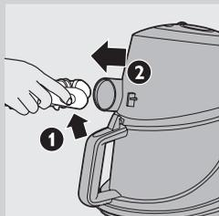
**2** 取下软管时，按下释放钮 (1)，将软管从吸尘器中拔出 (2)。
