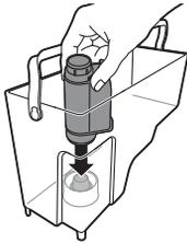
**4** Posizionate il filtro nel serbatoio dell'acqua vuoto. Premetelo verso il basso fino a che non può muoversi ulteriormente.
