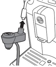
**警告：**裝回橡膠接頭時，請勿將接頭推超過蒸氣管上的線。若推過頭，自動奶泡機可能會無法從牛奶盒內吸取牛奶，因而無法正確運作。
