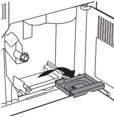
8 移除並清空咖啡粉殘渣槽後，在水龍頭下以溫水沖洗。晾乾後重新插入。
