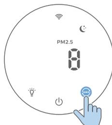
**Modo de reposo (crescent moon):** El purificador de aire funciona de forma silenciosa a una velocidad muy baja. Después de 3 segundos, la pantalla se apaga.
