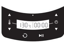
**Remarque :** pour alterner entre les degrés °C et °F, appuyez simultanément sur les boutons d'augmentation et de diminution de la température pendant 3 secondes.
