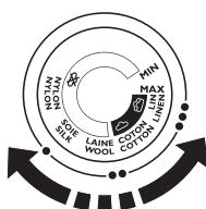
**3** Pentru a seta temperatura de călcare adecvată, reglați selectorul de temperatură pe poziția potrivită. (consultați tabelul de mai sus 'Setări pentru temperatură și abur').
