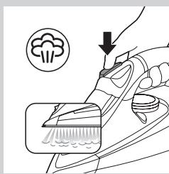
Усиливането на парата от гладещата повърхност с връх за пара помага за отстраняване на упорити гънки. То подобрява разпръскването на парата към всички части на дрехата.
