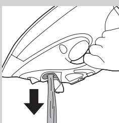
**1** Uzstādiet tvaika vadību 0. pozīcijā un atvietojiet gludekli no elektrotīkla.
