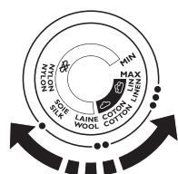
**3** Для установки необходимой температуры глажения поверните дисковый регулятор нагрева в необходимое положение (см. расположенную выше таблицу “Температурный режим и режим подачи пара”).
