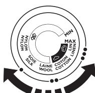
**3** Lai uzstādītu vajadzīgo gludināšanas temperatūru, pagrieziet temperatūras regulatoru atbilstošā pozīcijā (skatiet augstāk tabulu "Temperatūras un tvaika režīmi").
