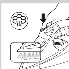
Паровий струмінь зі спеціального паруючого носика дозволяє усувати складні складки. Паровий струмінь покращує розподіл пари по тканині. Функцію парового струменя можна використовувати лише за температури між ●●● і MAX.
