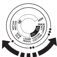
**3** Задайте необходимата температура на гладене чрез завъртане на температурния регулатор в съответното положение (вижте таблица "Настройки на температурата и парата" по-горе).
