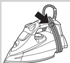
**4** Sietový kábel omotajte okolo výstupku na jeho odkladanie a zaistite ho svorkou na prichytenie kábla.
