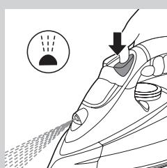
Funkciu kropenia môžete použiť pri akejkoľvek teplote, aby ste zvlhčili výrobok, ktorý idete žehliť. Toto Vám pomôže odstrániť nepoddajné záhyby.
