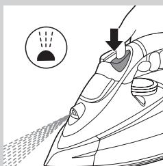
Можете да използвате функцията за пръскане при всяка температура за навлажняване на гладеното изделие. Това спомага за премахване на упоритите гънки.
