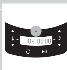
هنگامی که صفحه حرارتی یا ته دیگ به درجه حرارت تنظیم شده برسد، درجه حرارت در نمایشگر دیگر چشمک نخواهد زد. دستگاه درجه حرارت تنظیم شده را حفظ خواهد کرد و در همان حال شما می توانید کار دیگری را انجام دهید.
