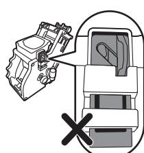
**Remarque : Le crochet n'est pas correctement placé s'il est toujours dans la position la plus basse.**
