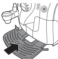
**5** Retirez l'autocollant de protection du plateau égouttoir et faites glisser le plateau égouttoir dans les rainures à l'avant de la machine.
