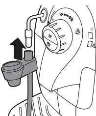
**6** Insérez le mousseur à lait automatique.
