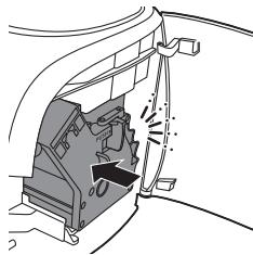
**10** Replacez le groupe café dans la machine en le faisant glisser le long des rainures latérales de guidage jusqu'à ce qu'il soit enclenché.
