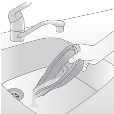
8 เนื่องจากที่ใส่คราบตะกรันจะร้อนขณะทำขั้นตอนขจัดตะกรัน ให้รอประมาณ 5 นาที ก่อนจับอุปกรณ์ จากนั้น นำที่ใส่คราบตะกรัน ไปเทสิ่งสกปรกออกที่อ่างล้างมือ แล้วจัดเก็บเพื่อใช้งานครั้งต่อไป
