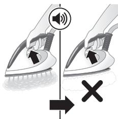
นอกจากนี้แล้ว ยังมีการป้องกันขั้นที่สองเพื่อป้องกันตะกรันจับเครื่องทำไอน้ำ ดังนี้ ฟังก์ชันไอน้ำจะปิดการทำงาน หากไม่มีการขจัดคราบตะกรัน หลังจากสิ้นสุดการขจัดคราบตะกรัน ฟังก์ชันไอน้ำจะถูกเปิดใช้งานอีกครั้ง โดยไม่คำนึงถึงประเภทของน้ำที่ใช้
