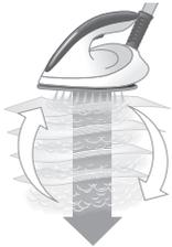
เทคโนโลยีนี้จะสร้างไอน้ำต่อเนื่องที่แทรกซึมลึกเพื่อรีดรอยยับได้อย่างง่ายดาย ในขณะที่เดียวกัน ยังทำให้เครื่องมีขนาดกะทัดรัดและเบากว่าเครื่องทำไอน้ำทั่วไป ทำให้จัดเก็บได้ง่ายยิ่งขึ้น
