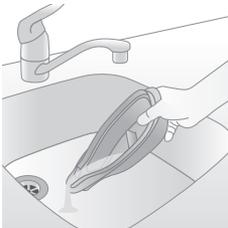
8 除垢容器在除垢过程中会变热，请等待大约 5 分钟后再接触。然后将除垢容器带到水槽处，将其清空并存储以备下次使用。
