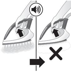
나아가 두 번째 보호 단계로 스팀 시스템 다리미에 석회질이 쌓이는 것을 방지합니다. 석회질 제거를 수행하지 않으면 스팀 기능이 작동하지 않게 됩니다. 석회질 제거를 마치면 스팀 기능은 회복됩니다. 이는 사용한 물 종류에 상관없이 동일하게 작동합니다.
