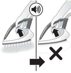
除此之外，还整合了次级保护步骤，能够保护蒸汽发生器，避免水垢积聚：如果没有进行除垢，将禁用蒸汽功能。除垢完成后，蒸汽功能将会恢复。无论使用哪种类型的水，这种情况都会出现。
