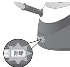
使用 1 至 3 个月后，除垢指示灯开始闪烁，产品开始发出蜂鸣音，表示您必须执行除垢流程。
