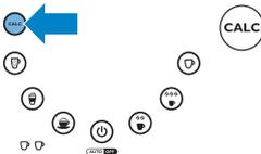
11. Appuyez sur le bouton CALC pour démarrer le cycle de rinçage. L'eau s'écoule en continu pendant environ 5 minutes. Attendez que la machine ait terminé le cycle de rinçage. Le bouton marche/arrêt clignote rapidement et le bouton CALC clignote lentement.
