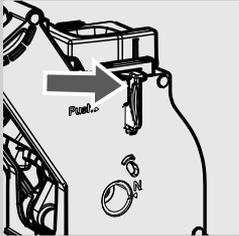
**8** Sicherstellen, dass sich der angegebene Haken für die Sperre der Brühgruppe in der korrekten Position befindet. Um dessen Position zu überprüfen, wird die Taste "PUSH" kräftig gedrückt.
