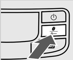
Durch Druck der Taste "☉" sind vier Möglichkeiten anwählbar (mild, mittelstark, stark, vorgemahlen).
