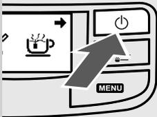
**5** Die gewünschte Heißwassermenge entnehmen. Um die Ausgabe des heißen Wassers abubrechen, wird die Taste "☞☜" gedrückt. Die Maschine schaltet auf Normalbetrieb um.
