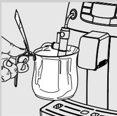
Um zu vermeiden, dass Wasser für längere Zeit im System verbleibt, muss das Wassersystem vor der ersten Inbetriebnahme der Maschine und nach einer längeren Nichtbenutzung entlüftet werden. Dies dient der Zubereitung eines perfekten und frischen Produktes.
