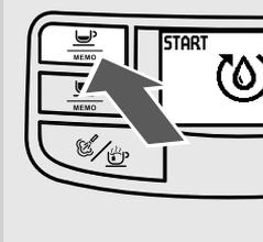
**2** "START" auswählen, indem die Taste "☕" gedrückt wird. Die Maschine führt nun die automatische Entlüftung des Systems aus, indem sie eine gewisse voreingestellte Menge Wasser aus dem Cappuccinatoren ablässt. Dabei wird die progressive Füllung der Leiste unter dem Symbol angezeigt.
