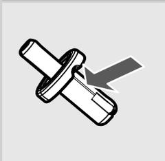
**15** Der Steckanschluss der Karaffe darf keine Milchrückstände aufweisen. Er ist mit einem feuchten Scheuerlappen zu reinigen.
