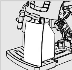
Nach der Zubereitung von Getränken mit Milch heißes Wasser aus der Dampfdüse (Cappuccinatore, soweit vorhanden), ausgeben, um diese zu reinigen.
