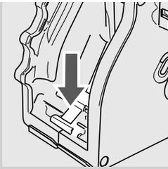
**7** Sicherstellen, dass der Hebel die Basis der Brühgruppe berührt.
