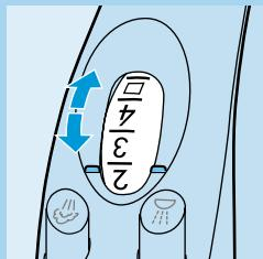
Εάν η επιλεγμένη ρύθμιση θερμοκρασίας είναι πάρα πολύ χαμηλή, μπορεί να τρέξει νερό από την πλάκα. Οι τύποι HI428 έχουν εξοπλιστεί με ένα σύστημα drip stop (ανατρέξτε στο "Drip stop" (σταμάτημα ροής) παρακάτω σε αυτό το κεφάλαιο.)
