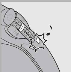
► **Lampen for automatisk avslåing begynner å blinke, og du vil høre et lydsignal som indikerer at varmeelementet er slått av.**
