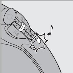
► **Lampan för automatisk avstängning börjar blinka och du hör en signal vilket anger att värmeelementet har stängts av.**
