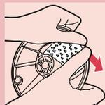
**8** Ta av insatsen från insatshållaren genom att ta tag i den med baksidan vänd mot dig. Tryck på insatsens sidor med tummarna. Insatsen lossnar då från hållaren.
