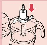
**2** Sätt hållaren i skålen och sätt sedan kniven på hållaren.
