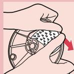
**8** Når De skal fjerne skiven fra skiveholderen, tar De skiveholderen i hånden med baksiden pekende mot Dem. Ved å presse endene på skiven fremover med tomlene, faller skiven ut av holderen.
